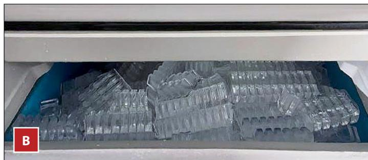
Fig. 5. Depósitos de hielo con (A) y sin (B) deflector de zona de caída.
