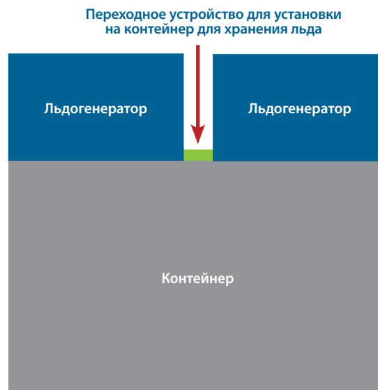
Рис. 2. Льдогенераторы установлены с обеих сторон бункера.
