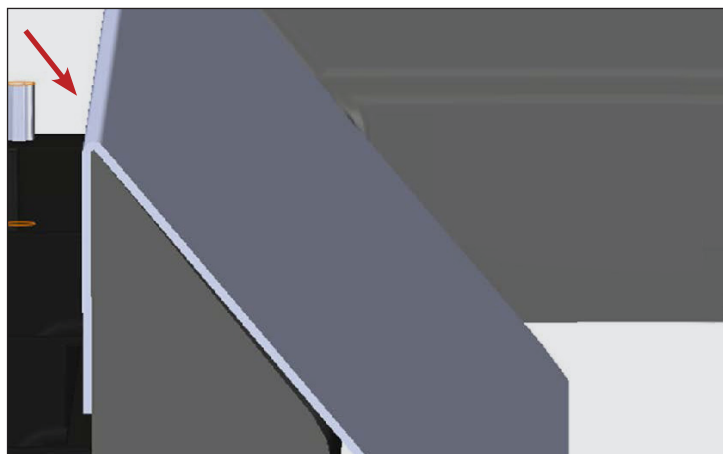
Рис. 4. Установлен дефлектор зоны выдачи льда, вид сбоку.
