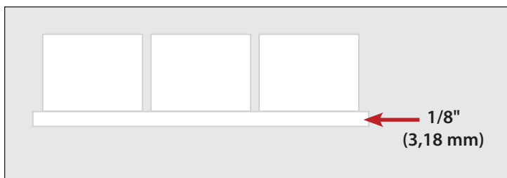
Rys. 1. Mostek lodowy scala kostki lodu w bloku.
