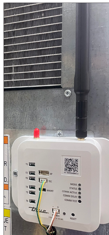
Rys. 3. Zainstalowana na modemie antena. Antena może w rzeczywistości być nieco inna.
