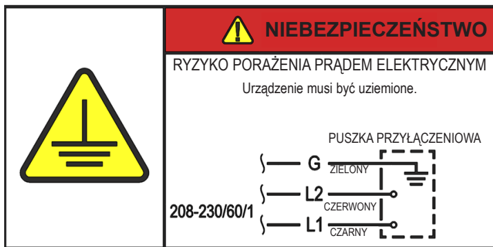
Rys. 4. Etykieta elektryczna skrzynki przyłączeniowej.
