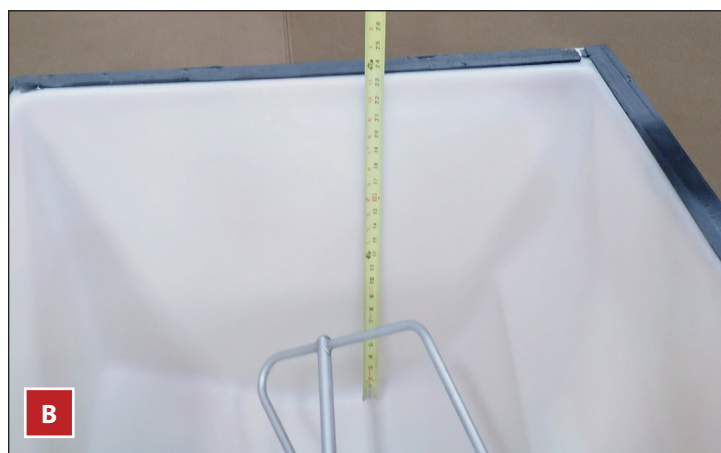
Rys. 2. Zawsze przed instalacją kostarki do lodu wykonać pomiary zasobnika (A) lub dystrybutora (B) na potrzeby czujnika poziomu kostek lodu.
