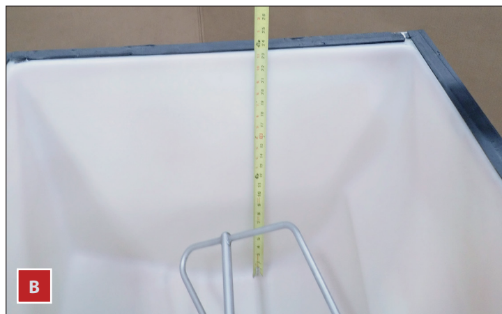
Afb. 2. Meet altijd de bak (A) of dispenser (B) voor de ijsniveausensor voordat u de ijsmachine monteert.
