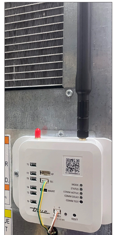
Afb. 3. Antenne op modem geïnstalleerd. Uw antenne kan afwijken.
