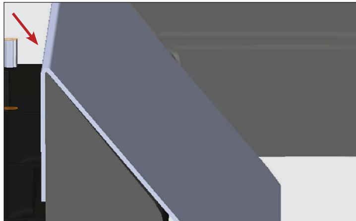
**Fig. 4** Visione di lato del deflettore della zona di rilascio installato.
