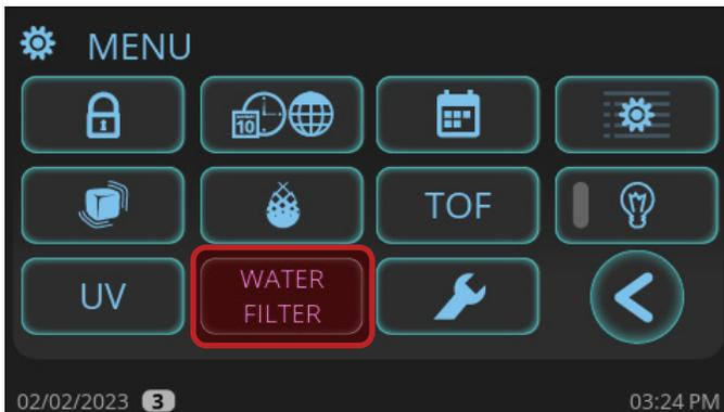
3. Nella schermata **Filtro dell'acqua**, selezionare il filtro dell'acqua appropriato per la vostra applicazione. TRUE offre sistemi di filtrazione dell'acqua Standard e Platinum. Se si utilizza un filtro dell'acqua non di marca TRUE, inserire la capacità d'acqua sotto **PERSONALIZZA**. Vedere la capacità d'acqua nella tabella sulle capacità dei filtri dell'acqua.
