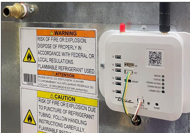
Figure 2. Faisceau raccordé au modem. Jaune/vert sur TEC ; marron/blanc sur POWER.
