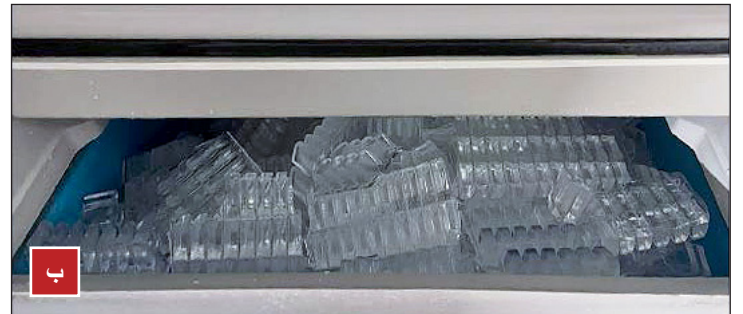
الشكل 5. صناديق الثلج المزودة باللوحة العاكسة لمنطقة سقوط الثلج من النوع (A) وليس من النوع (B).
