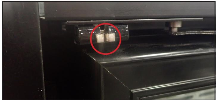
**Fig. 6.** Clip de maintien de la charnière installé dans la charnière supérieure. Comprimez le clip avec une pincès et tirez.
