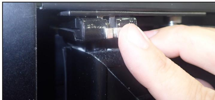
Fig. 12. Inserte el clip de retención de la bisagra.
