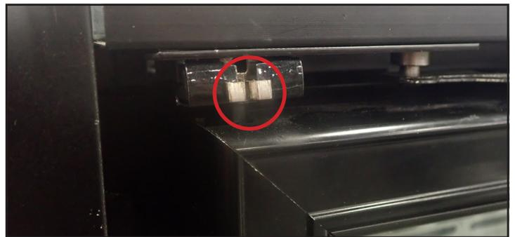
**Fig. 6.** Clip de retención de la bisagra instalado en la bisagra superior. Comprima el clip con unos alicates y tire.
