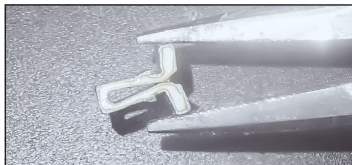
Fig. 10. Apriete el clip de retención de la bisagra.
