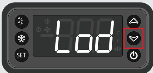
3. Pulse el botón de punto de ajuste. La pantalla muestra la sonda actual
