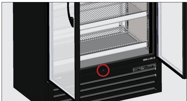
Fig. 1. Ubicación del tornillo de la rejilla apersianada de la puerta batiente.
