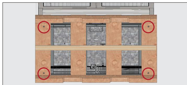
Fig. 4: Localização dos parafusos de transporte.
