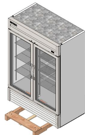
Fig. 5 Se verranno utilizzati piedi o rotelle di livellamento, ruotare l'elettrodomestico sul pattino.
