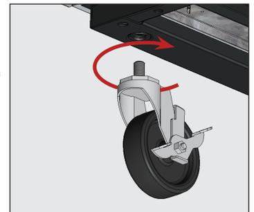
Fig. 8. Atornille las ruedecillas en los orificios roscados.
