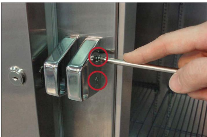
**Fig. 5** Ubicazioni delle viti del chiavistello della serratura.
