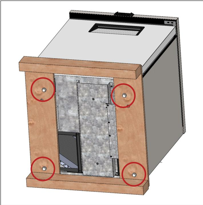
**Abb. 3.** Alle Transportschrauben entfernen.
