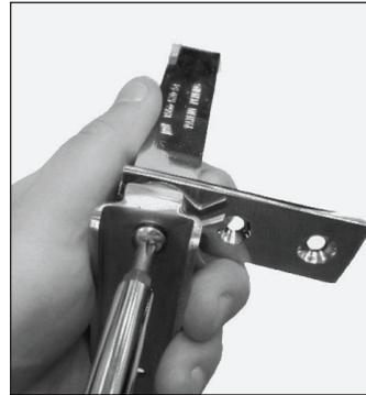
Abb. 6. Die Drehzapfenhalterung von der Hülsenfeder entfernen und dann drehen.
