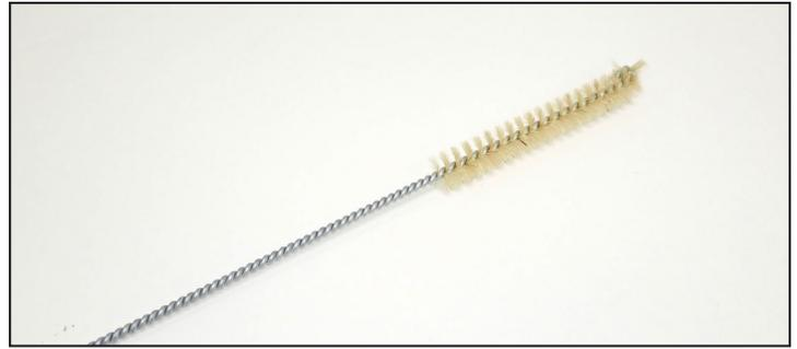
Abb. 1. Schmale Schlauchbürste.
