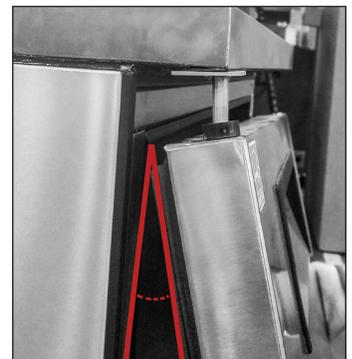
Abb. 10. Gegebenenfalls beim Positionieren der Tür nur flache Winkel wählen.
