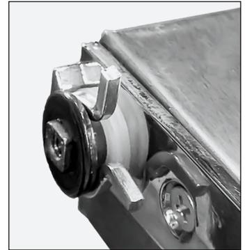
Abb. 7. Die Unterlegscheiben in der richtigen Montagereihenfolge aufbewahren.
