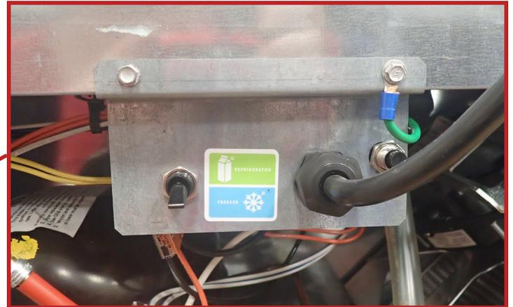
Abb. 1. Anordnung des TRUE FlexTemp-Umschalters
