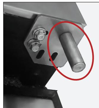
**Abb. 2.** Nicht die Buchse am oberen Scharnier abbrechen.
