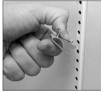
Abb. 1. Befestigung der oberen Lasche des Halters
