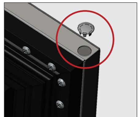
Fig. 11. Install the plug.
