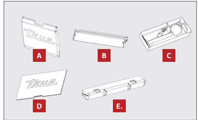
**A. Cortina de agua:** retire colocando una mano sobre el borde superior de la cortina y la otra mano en el costado de la cortina. Flexione suavemente la cortina del costado hacia el centro mientras tira con cuidado de la parte superior hacia afuera.
