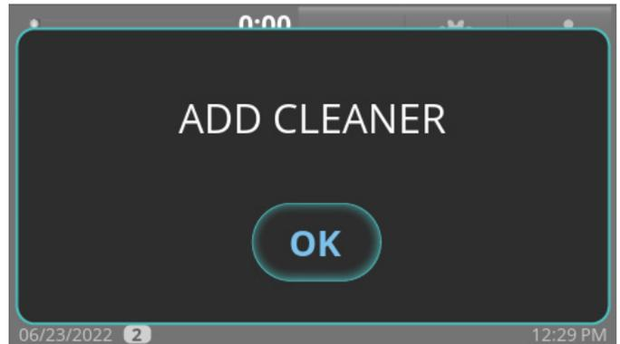
8. Después de agregar el desincrustador, presione **OK** [ACEPTAR]. La pantalla mostrará entonces el estado de la secuencia. **AVISO** La secuencia no continuará a partir de este punto, a menos que se presione **OK** [ACEPTAR] después de agregar el limpiador. Cuando finalice el procedimiento, la máquina de hielo entrará automáticamente en la secuencia de desinfección.
