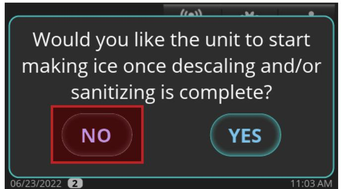
7. Espere a que la máquina de hielo pase por la secuencia PRE-CLEANING [LIMPIEZA PREVIA] (FILL [LLENAR], PUMP [BOMBLEAR], DRAIN [DRENAR] y HARVEST [RECOLECTAR]). Si hay suficiente agua en el colector al inicio de CLEAN [LIMPIAR], pasará por una secuencia DRAIN [DRENAR] antes de FILL [LLENAR]. El compresor arrancará durante la secuencia HARVEST [RECOLECTAR] para garantizar que no haya hielo en el evaporador y se apagará antes de que continúe la secuencia CLEAN [LIMPIAR].
