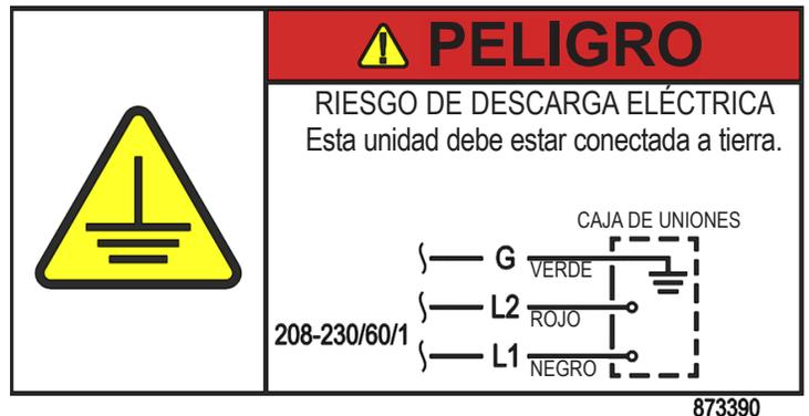
**Fig. 4.** Etiqueta eléctrica de la caja de uniones.
