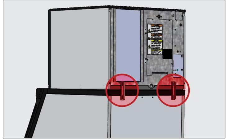
**Fig. 1.** Soportes del depósito instalados.
