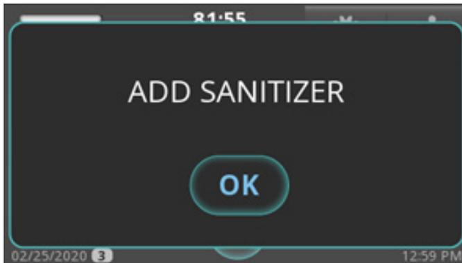
11. Después de agregar blanqueador de cloro (hipoclorito de sodio al 5,25 %), presione **OK [ACEPTAR]**. La pantalla mostrará entonces el estado de la secuencia.
