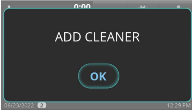
9. Después de agregar desincrustador, presione OK [ACEPTAR]. La pantalla mostrará entonces el estado de la secuencia.
