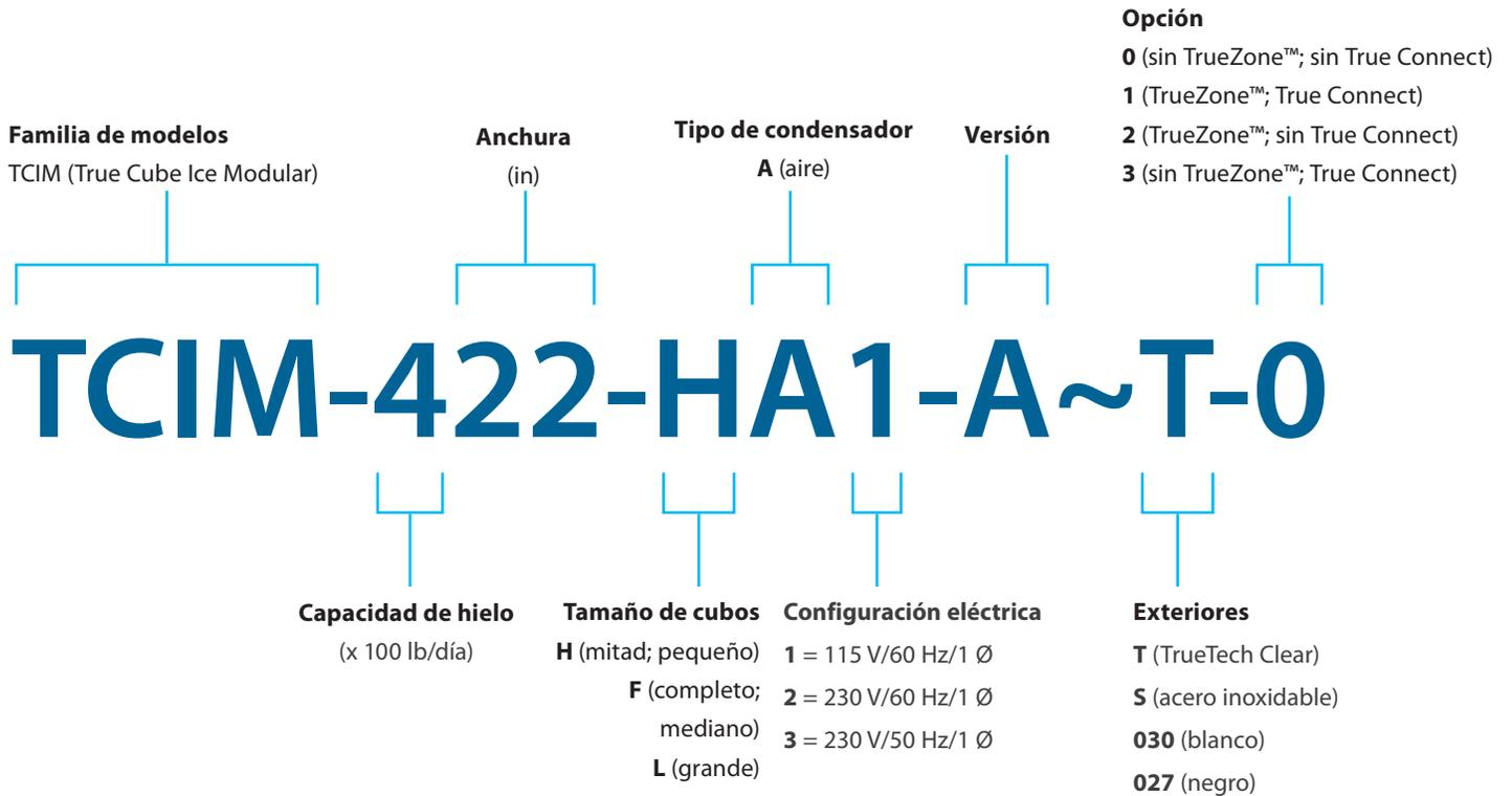
Fig. 1. Diagrama de nomenclatura del modelo TCIM.
