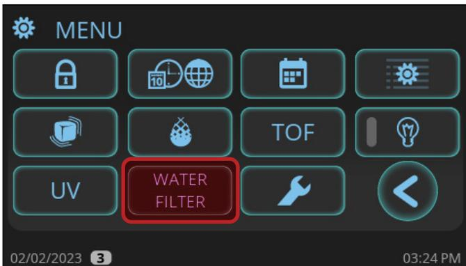
3. En la pantalla “Water Filter” [Filtro de agua], seleccione el filtro de agua adecuado para su aplicación. True ofrece sistemas de filtración de agua Standard y Platinum. Si usa un filtro de agua que no es de TRUE, ingrese la capacidad de agua en **CUSTOM [PERSONALIZADO]**. Consulte las capacidades de filtrado en la tabla de capacidades de filtrado de agua.
