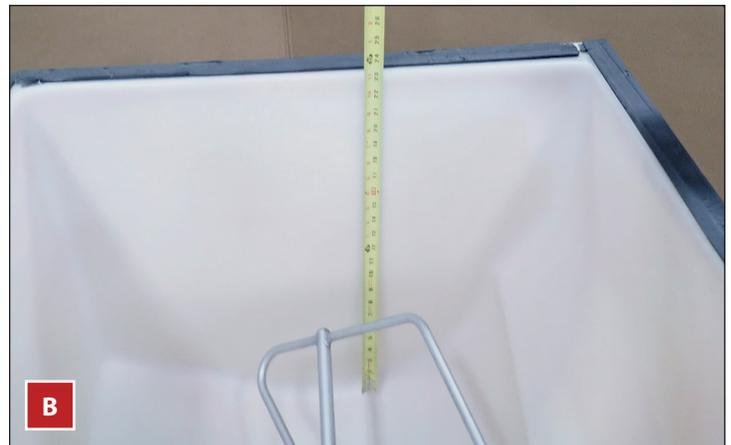
**Fig. 2** Misurare sempre il contenitore (A) o l'erogatore (B) per il sensore del livello del ghiaccio prima di montare la macchina del ghiaccio.
