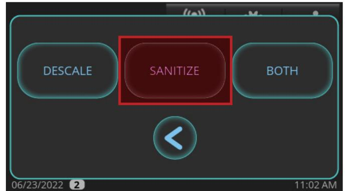
8. Quand apparaît le message "**Voulez-vous que l'appareil commence à fabriquer de la glace une fois le détartrage et/ou la désinfection terminés ?**" appuyez sur **NON** ou **OUI**. La machine à glaçons passe en **PRÉNETTOYAGE**.
