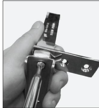
**Fig. 6.** Déposez le support de charnière du ressort de la cartouche avant de le faire pivoter.
