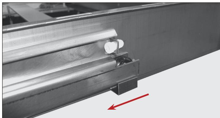
**Fig. 2.** Agrafe de roulette en position basse.
