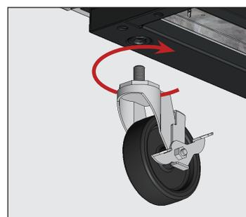
Figure 8. Vissez les roulettes dans les trous filetés.
