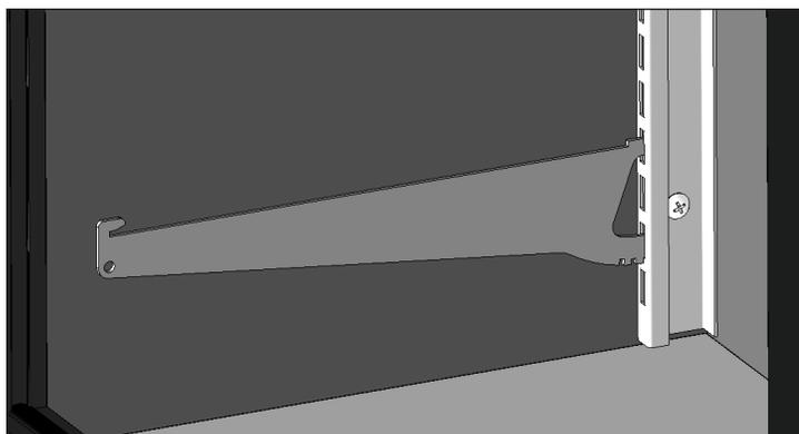
**Fig. 4.** Staffa di supporto della mensola installata.
