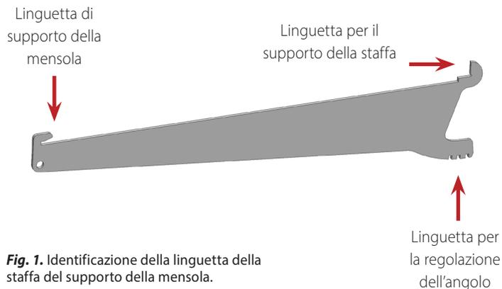
**Fig. 1.** Identificazione della linguetta della staffa del supporto della mensola.
