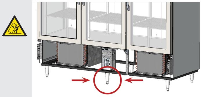
Un corretto livellamento del vostro refrigeratore TRUE è fondamentale per un buon funzionamento (per modelli non mobili). Il livellamento impatta la rimozione della condensa efficace e il movimento dello sportello.
