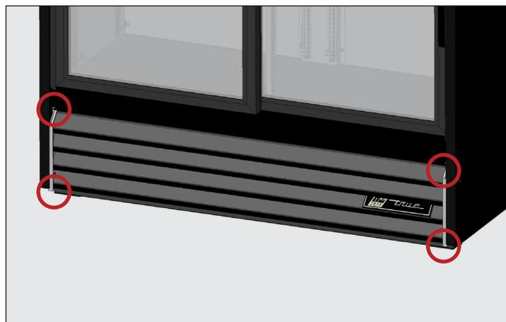
**Fig. 2.** Ubicazione della vite della griglia dello sportello a scorrimento.
