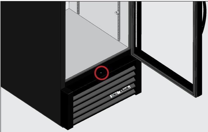
Abb. 1. Position der Schrauben am Lamellengitter der Schwenktür.
