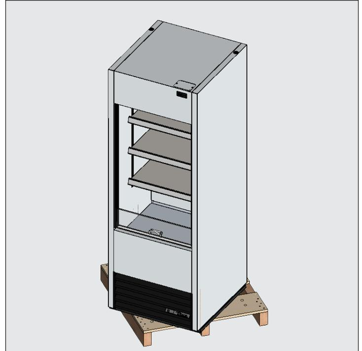
Fig. 3. Pour le levage de l'appareil, ne pas utiliser les plans de travail, les portes/tiroirs ni les grilles comme point de levage.
