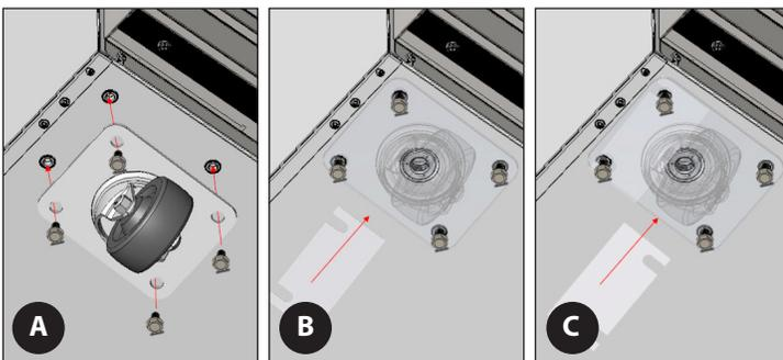
**Fig. 7.** Installez les cales de roulettes par paires.
