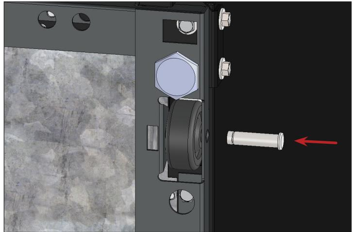
**Fig. 12.** Insert the pin.
