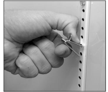
Fig. 7. La pestaña inferior del elemento de fijación del estante quedará bien encajada.
