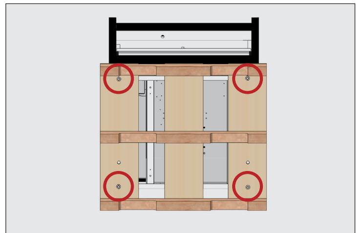
**Fig. 2.** Retire todos los pernos de transporte.
