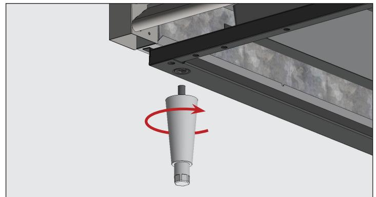
**Fig. 5.** Enrosque los pies de nivelación en los orificios roscados.
