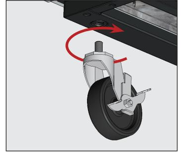
Fig. 8. Enrosque las ruedas en los orificios roscados.
