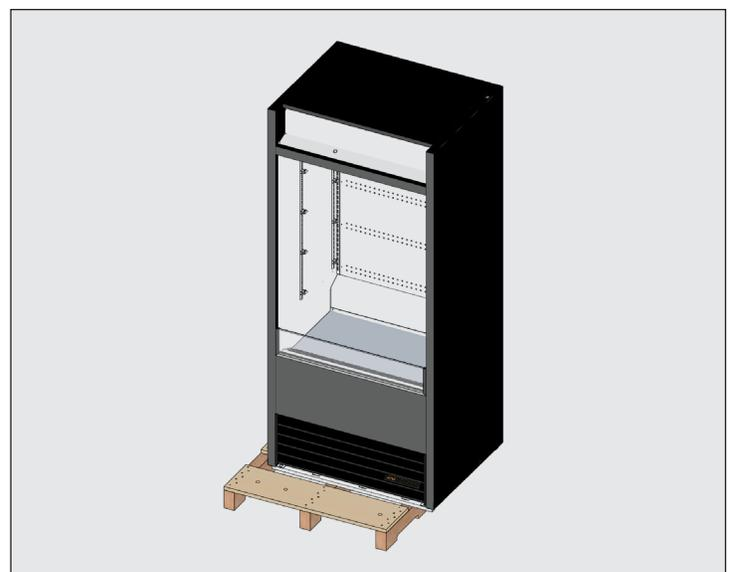
**Fig. 3.** Retire el gabinete de la plataforma de madera y deje la plataforma a un lado.
