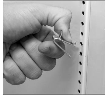
Abb. 6. Befestigung der oberen Lasche des Halters
